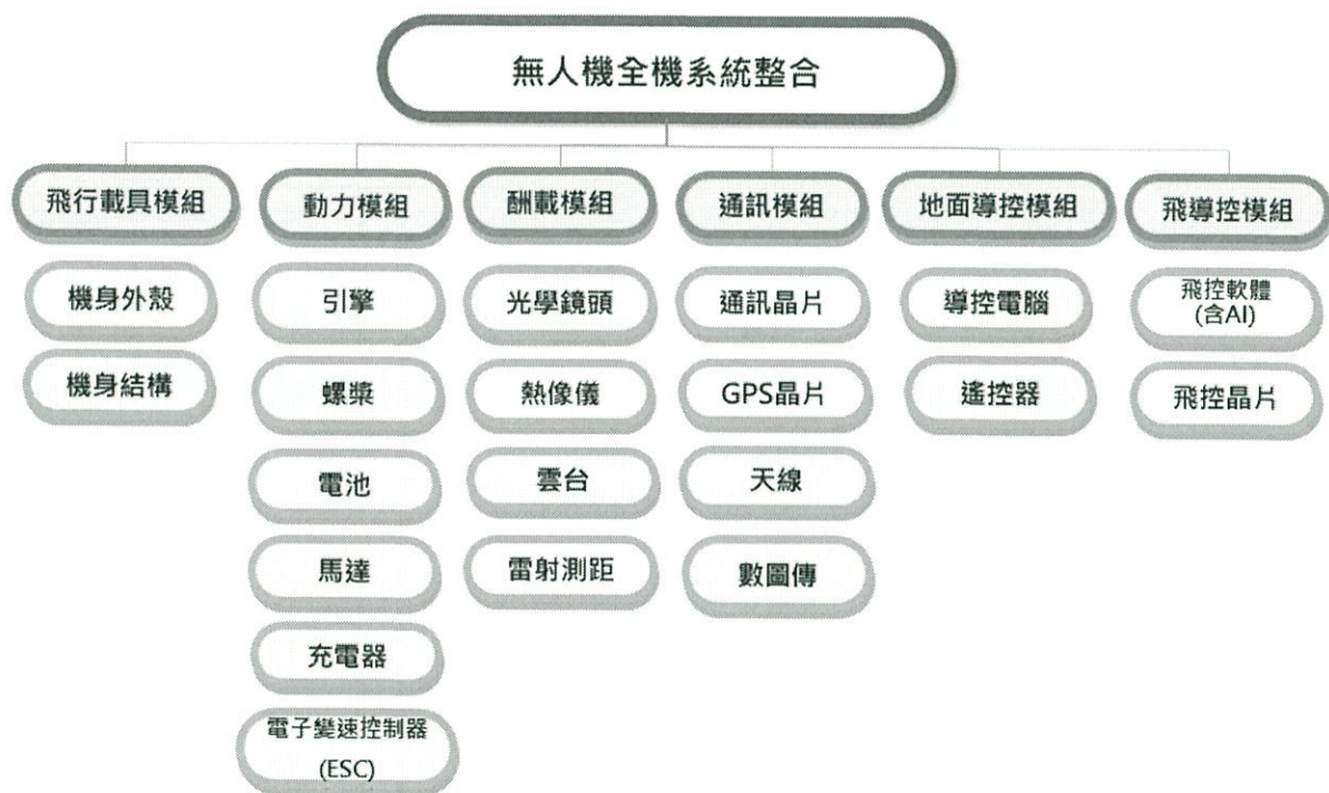
圖 2 無人機全機系統示意圖
