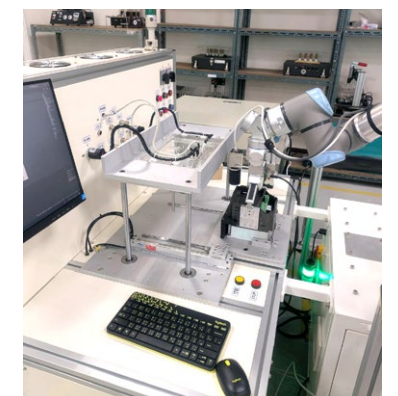
變頻器動力自動校驗系統 — 機器手臂夾取搬運變頻器
