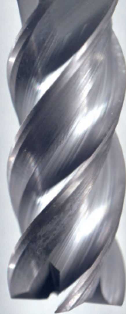
APC強力銑刀夾頭 有微細的磨損 最令人滿意 可繼續加工
