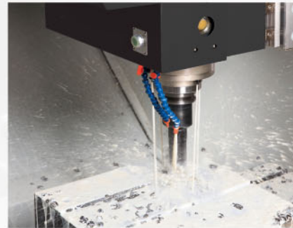
鑽孔 ● 刀徑：Ø49 ● 轉速：800 rpm ● 進給：250 mm/min ● 深度：147 mm
