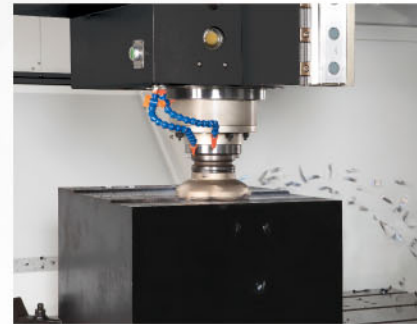
面銑削 ● 刀徑：160 mm ● 轉速：450 rpm ● 進給：810 mm/min ● 深度：6 mm ● 切寬：130 mm ● 移除率：631 cm 3 /min
