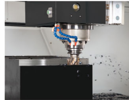
端銑削 ● 刀徑：63 mm ● 轉速：800 rpm ● 進給：400 mm/min ● 深度：40 mm ● 切寬：10mm
