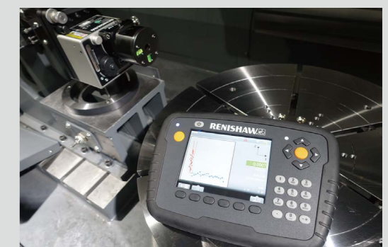
RENISHAW直線度 / 平行度 / 垂直度雷射檢驗儀 Parallelism / Straightness / Perpendicularity (RENISHAW)
