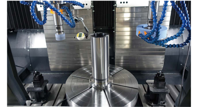
標準棒研磨 Standard test bar grinding
