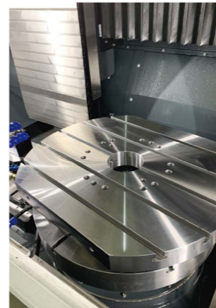
第四軸盤面研磨 Table grinding
