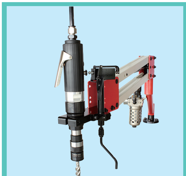
TM 80037 自動反轉裝置 Auto Reverse Device
