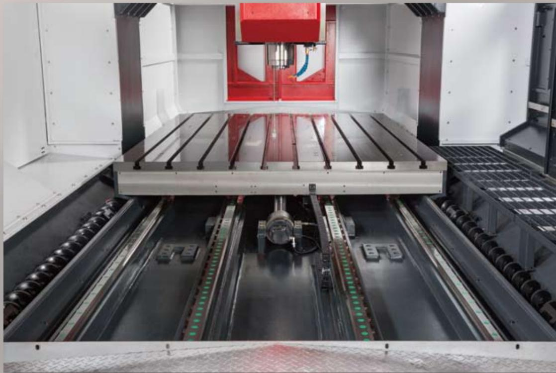
X軸4條精密線軌，螺桿末端配置高解析度解碼器+螺桿中空冷卻裝置
