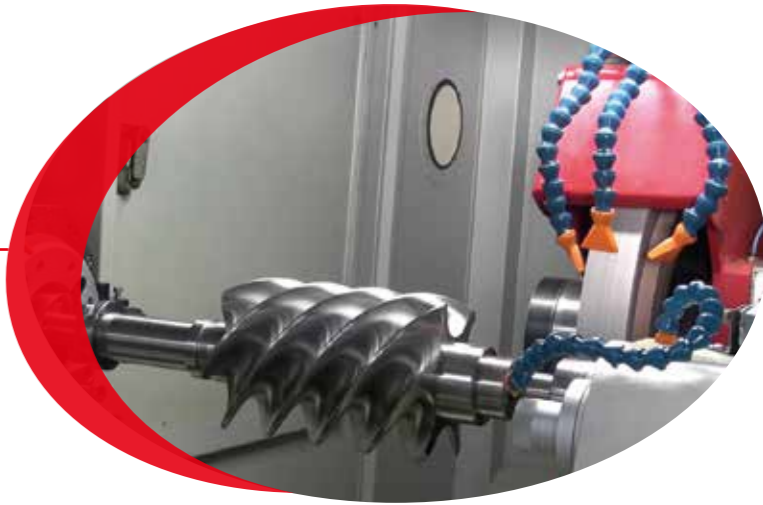
工件名稱:空壓機轉子 產品型號:EGP-3260CNC
