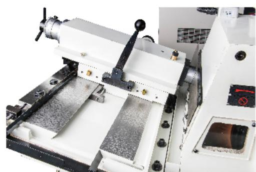
砂輪修整座的下滑滑道為下凹鳩尾槽設計，配合超大滑道面，大幅提升砂輪修整時的穩定性。
