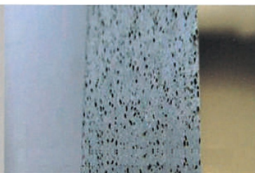
砂輪表面有明顯的氣孔
