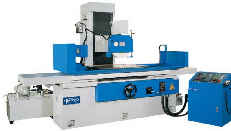
PFG-60100AHR // 600x1000mm 工作台面積 + NC上下自動進給系統與NC自動砂輪平行修整與補償系統 (選購) • 左右油壓驅動 • 前後自動進給 • 上下AC伺服馬達驅動 • 左右電子式換向
