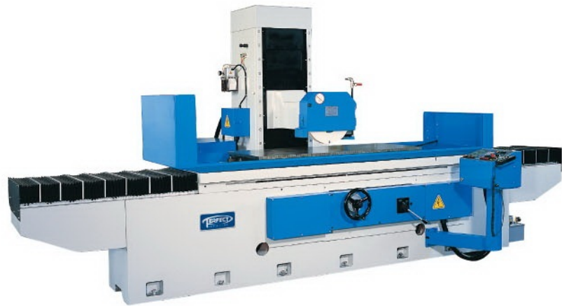
PFG-60150AHR // 600x1500mm 工作台面積 + NC上下自動進給系統 (選購) • 左右油壓驅動 • 前後自動進給 • 上下FAC伺服馬達驅動 • 左右電子式換向
