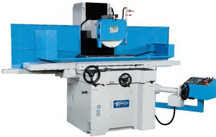
PFG-D4080AH // 400x800mm 工作台面積 + NC上下自動進給系統與砂輪平行修整 (選購) • 左右油壓驅動 • 前後自動進給 • 上下手動操作 • 左右電子式換向 • 連續式潤滑系統
