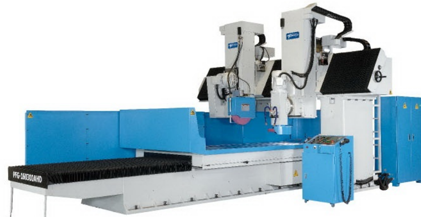
PFG-160300AHD // 1600x3000mm 工作台面積 + 立式主軸裝置 (選購) • 左右比例閥油壓驅動及電子式換向 • 前後及上下AC伺服馬達驅動 • NC上下自動進給系統
