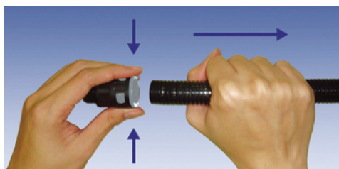
拆卸：握住接頭活動外殼，軟管往外拉。
