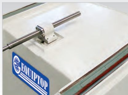
具備高剛性雙V軌道鑄件結構
