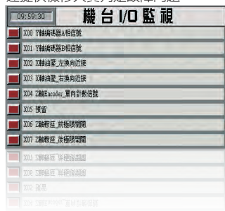
可監看輸入 / 輸出之信號狀態，可快速提供檢修人員判定故障問題
