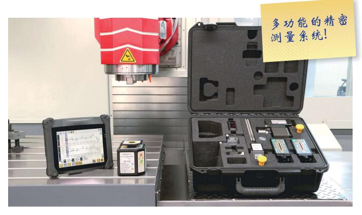
全新的ProLine套装的核心是T430激光发射器,唯一的可以真正自动标定,全数字,完全遥控操作的高精度 旋转扫描激光器。智能化的T430激光器还拥有环境温度及振动补偿 传感器,确保测量结果精准可靠。T430 可以按指令精确调整至于某一基准线或某一基准平面重合。无需更长的调整时间,就可以快速进行测量。 所有组件之间通过蓝牙无线连接,如果用户仍然仅仅习惯于使用传统测量设备及工艺,StatusPro的全新测量技术将会使您叹为观止。
