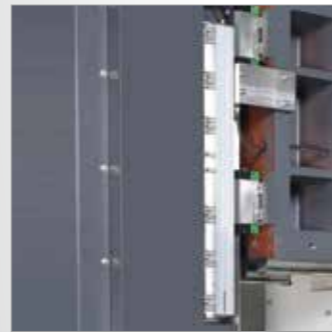
/ 光學尺 X, Y, Z 軸裝置海德漢光學尺
