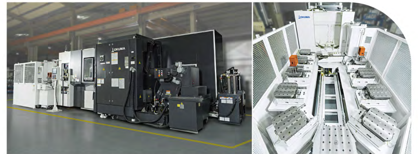
底座採用OKUMA臥式12盤加工中心機
