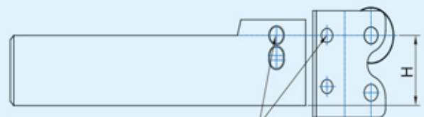
使用單輪刀片螺絲鎖緊的位置 Locking Screw Position For Single Knurling Wheel
