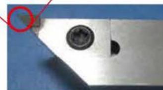
■ 超硬合金切削後の逃げ面損耗の比較
