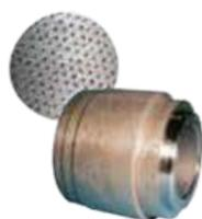
RZタイプ同様、精密電鍍技術により製作いたします。このタイプはダイヤモンドを規則的にセットしていますので、集中度をニーズに合わせて選択できます。またプロフィール形状成形のため、ダイヤモンド表面にラッピングを行います。独自技術によって、ラップ量を微量に抑え、切れ味が損なわれることはありません。主としてブランジドレッシングの大径サイズに適しています。
