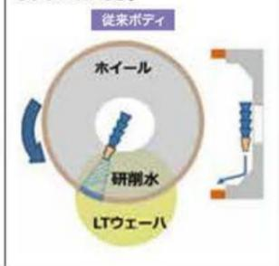
新設計ボディにより、研削液を研削点に均一に供給し熱変化を抑制することで、ウェーハの割れを抑制することが可能となった。
