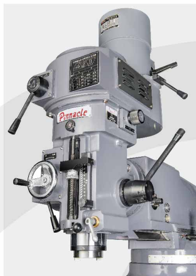
Q2S 齒輪式有段變速機頭
