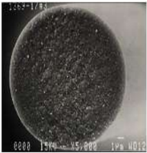
水晶纖維油石刷纖維斷面 Section of Cristone Bristle fiber 奈米結晶 nano (n) combination
