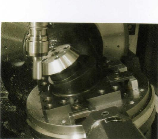
在依照NAS979 (该标准作为五轴联动加工精度的评价方法得到广泛应用) 进行的倾斜圆锥加工试验中, 本机床的圆度达到 $2.32\mu\text{m}$  (实测值), 实现了压倒性的高精度。
