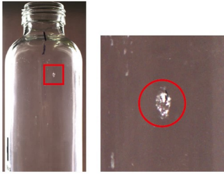
玻璃瓶 / 破損、裂開、異物
