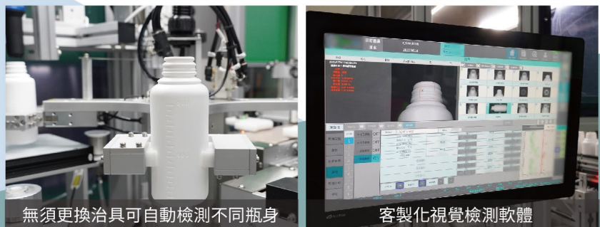
多隻光學鏡頭 + 新式旋轉夾具 360度多角度拍攝
