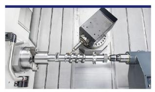
B軸 使用無背隙滾子凸輪驅動,最大扭力可達 970Nm,可減少背隙, 傳動效率極高。
