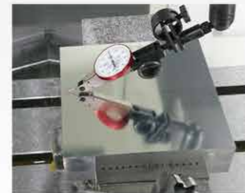
DYPEC ® 功能測試 - 鏡面切削。
