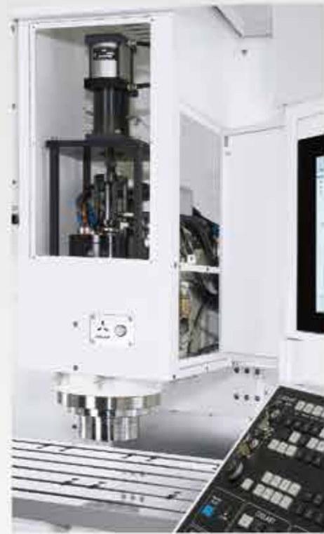
機器頭部於正面及側面皆有快拆式板金，方便維修及保養。
