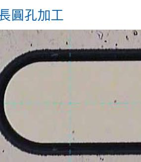
加工方式：鑽破後磨邊
