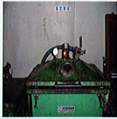
真空含浸設備
