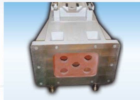
立柱具有多層箱型肋構造
