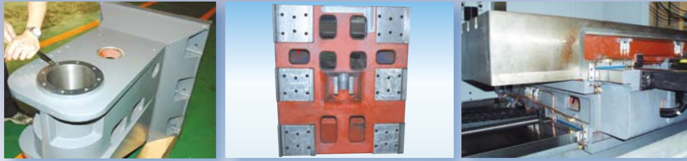
主軸頭劃花，保持主軸最佳精度
