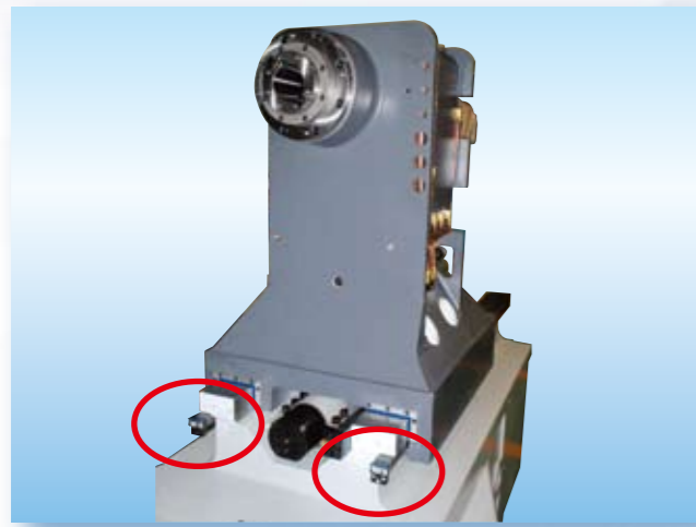
3軸共有18支調整斜楔，防止頭部下垂和抑制鞍座、工作台左右前後移動時產生螃蟹走路的缺點
