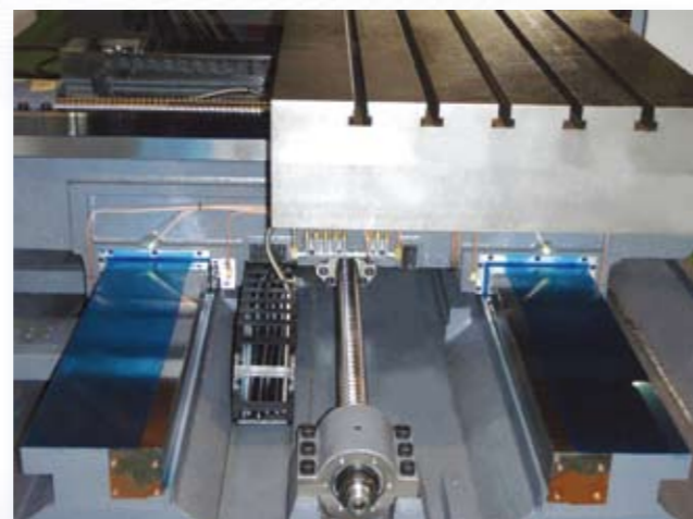
伸縮鈹金的支撐輪，放在滑軌側邊，可防制「刮傷滑軌」，長時間保持機器精密度，降低加工件誤差
