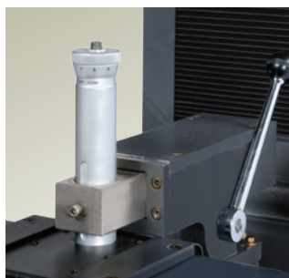
• 手動平行修整器 適用於 355mm 之砂輪
