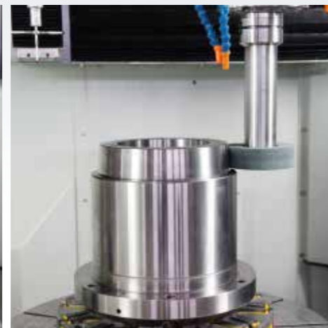
外徑斜度平面研磨 (二軸同動，斜度5度)
