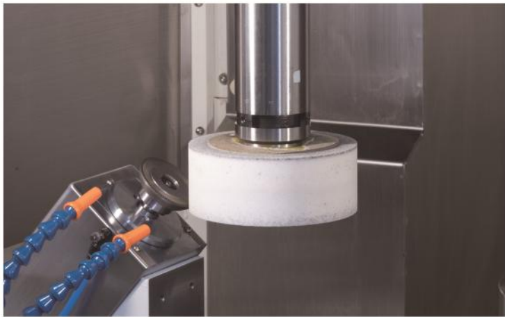
旋轉修砂，自動補償功能 Auto-dressing & Auto-compensation
