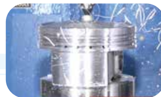
半精車、 粗車環槽及倒角 Semi-Finish Turning, Rough Grooving & Chamfering
