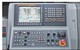
JSL-20RB/20RBY 發那科32iB CNC控制器 · 操作面板可移動及旋轉，方便操作者使用。
