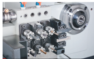
JSL-20RBY 副主軸刀具系統 · 副主軸刀具系統，適用於工件之背面加工。
