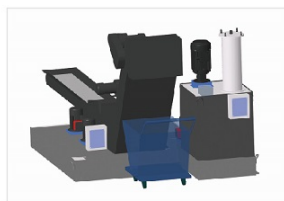
主軸中心出水 主軸中心出水副水箱直結安裝於 水箱上(選配)
