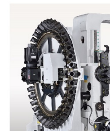
自動刀具交換系統(40支刀)- MH-400Plus用 伺服放射狀圓盤刀庫， 最大刀長450mm，鏜孔從 對鏜進階到一次貫穿，縮 短切削時間並保持一致的 精度
