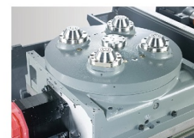
交換工作台錐體吹氣裝置 在交換台更換時，可清除遺留鐵 屑，以確保準確度及交換台定位
