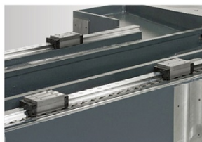
高速滾柱線軌 X/Y/Z軸之線性滑軌設計，可以提高加工之精度，同時可確保高速時之進給率
