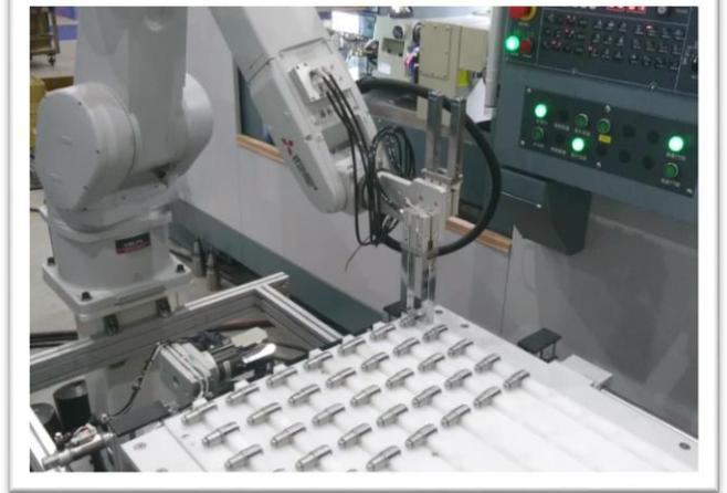
心得科技整合機械手臂、客製化料台、量測站與量測軟體，打造自動化機台，解決人力工時、工件品質保障、加工產能等製程問題，大幅提升加工機附加價值和競爭力。
